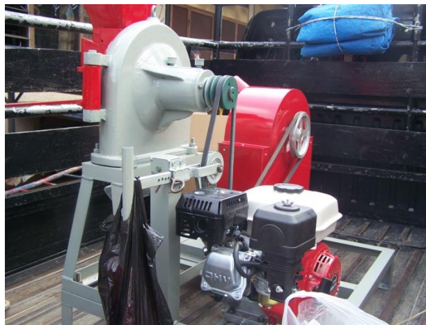
Gambar 3. Mesin penyawut dan penggiling tepung sukun berbahan bakar bensin
